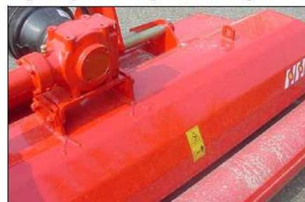
**Esempio di protezione superiore in lamiera**
